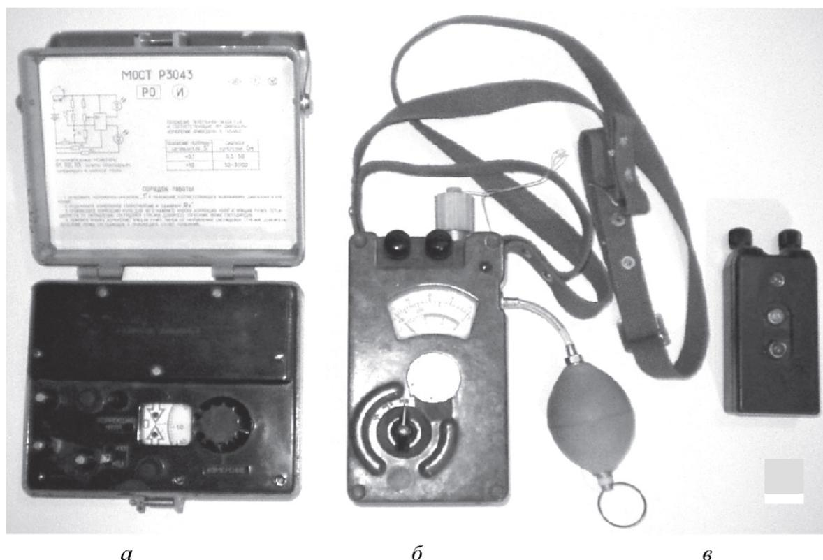
Рис. 11. Общий вид серийно выпускаемых приборов: *а* – мост переносной постоянного тока Р 3043; *б* – манометр с измерителем взрывной цепи ИМС-1; *в* – испытатель взрывной
