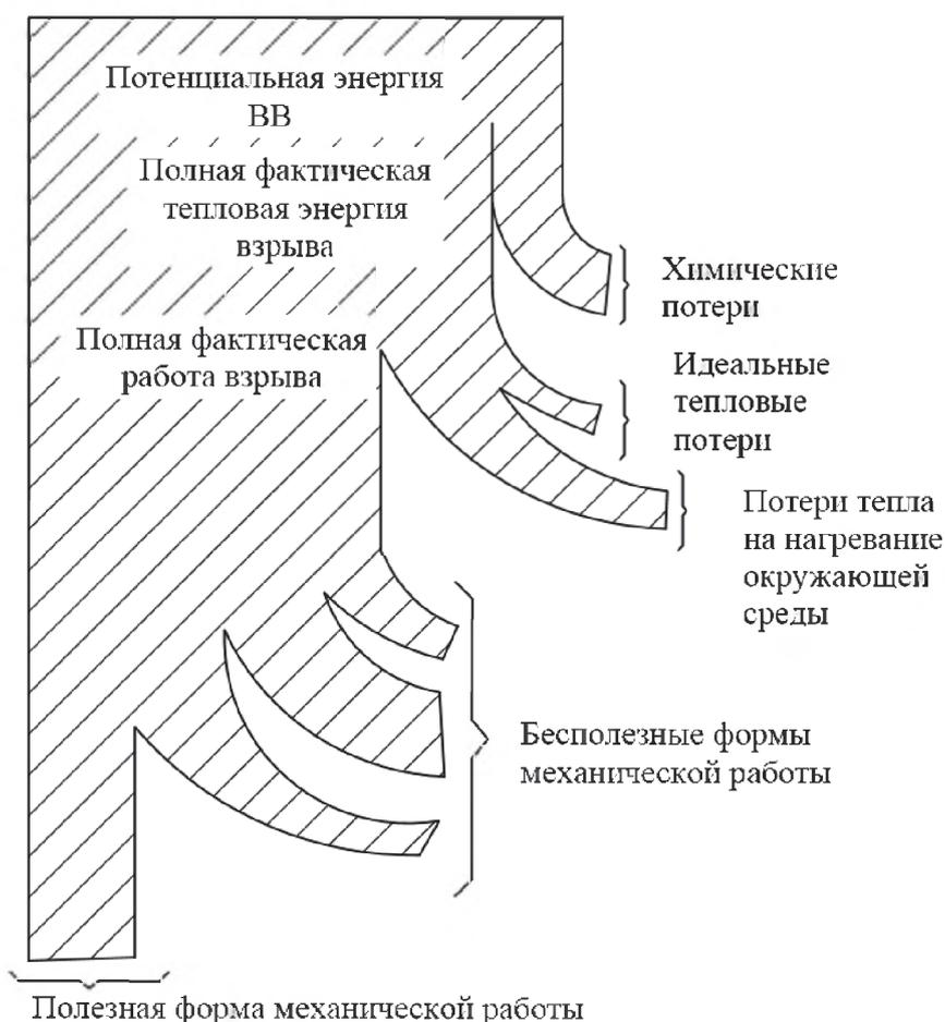
Рис. 3. Схема баланса энергии при взрыве (по А. Ф. Беляеву)
