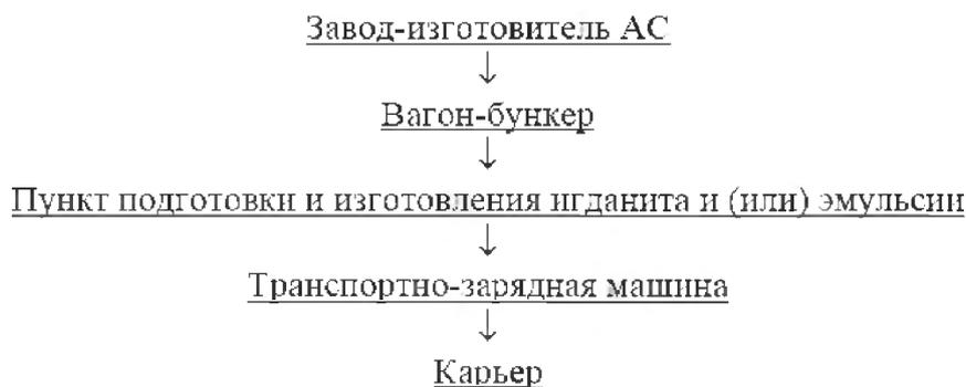
Рис. 42. Схема комплексной механизации взрывных работ при изготовлении на прикарьерном пункте простейших ВВ типа игданита и эмульсионных ВВ при поставке аммиачной селитры в вагонах-бункерах
