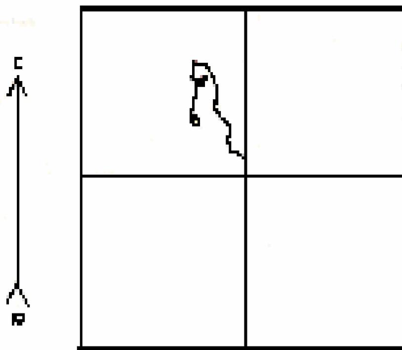
Рисунок А3- Инклинометрия скважины 251119 на площади 20×20
