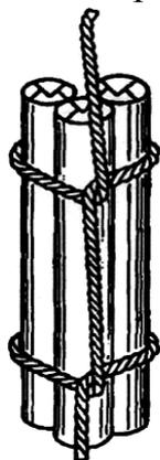
Рис.3.1. Схема соединения патрона-боевика с ДШ
