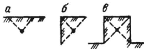
Рис. 6.11. Схема к определению влияния числа открытых поверхностей на объём разрушения: а, б, в – одна, две и три открытые поверхности
