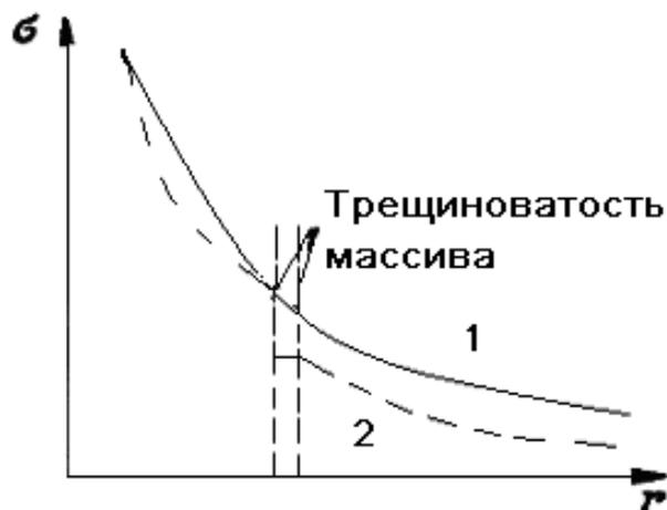
Рис. 6.8. Характер затухания энергии взрыва в монолитном (1) и трещиноватом (2) массиве
