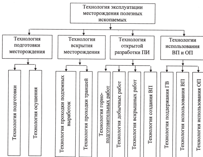
Рис. 1.5. Структура технологии открытой эксплуатации месторождения полезных ископаемых
