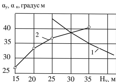
Рис. 6.4. График зависимости углов откоса уступа по условиям устойчивости  $\alpha_y$  (1) и минимально возможного  $\alpha_k$ , (2) от высоты уступа  $H_y$
