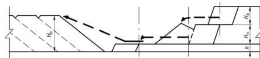
Рис. 2.17. Схема разработки вскрышного уступа с разделением по высоте
