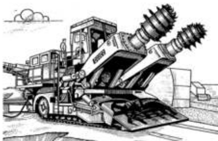
Рис. 3.17. Добычной комбайн для разработки полезного ископаемого без предварительного рыхления
