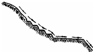
Рис. 2.8. Инверсионная схема воздухообмена в косогорном карьере без замкнутого контура
