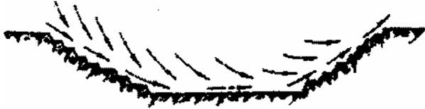
Рис. 2.9. Инверсионно-конвективная схема воздухообмена в карьере
