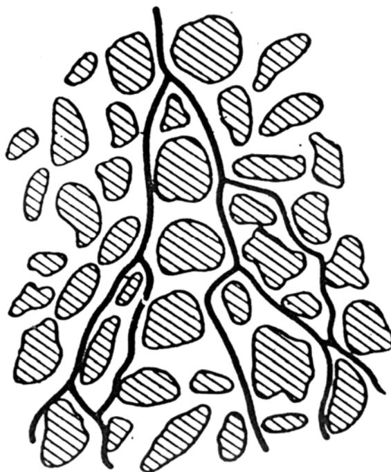
Рис. 30. Схема просачивания воды через зону аэрации (по А. И. Силину-Бекчуруну)
