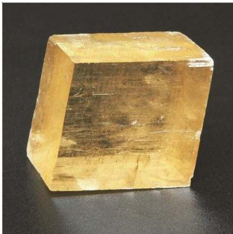
Рис. 2.68. Исландский шпат [75] – бесцветная прозрачная разновидность кальцита. Применяется в оптике – например для изготовления призмы Николя поляризационных микроскопов
