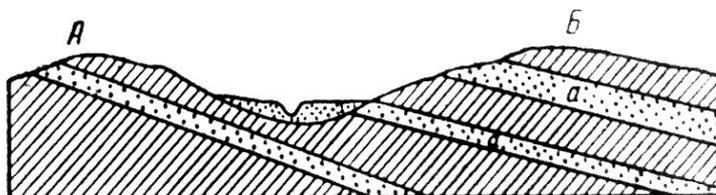
Рис. 4. Сток поверхностного бассейна (АБ) направлен к реке, сток подземного бассейна (а) – от реки.
