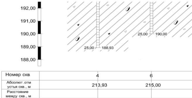
Рис. 3. Пример заполнения информационной таблицы под геологическими разрезами
