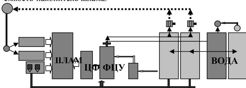
Рис. 10.3.1. Схема циркуляции раствора системы безамбарного бурения
