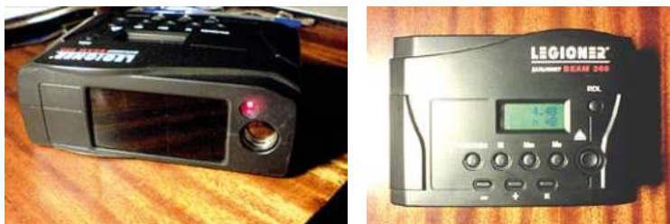
Рис. 3.8. Дальномер, снабжённый двумя лазерными излучателями (дальность измерения до 270 м)
