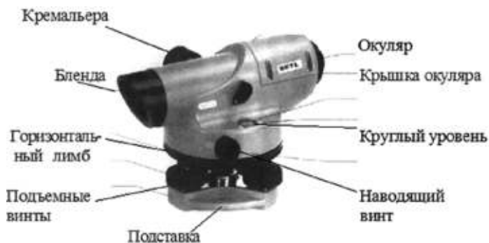
Рис. 4.1. Нивелир с компенсатором АТ-24Д (КНР)
