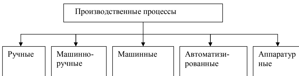
Рис.7.1. Классификация производственных процессов ремонта АТС в зависимости от степени участия в них человека
