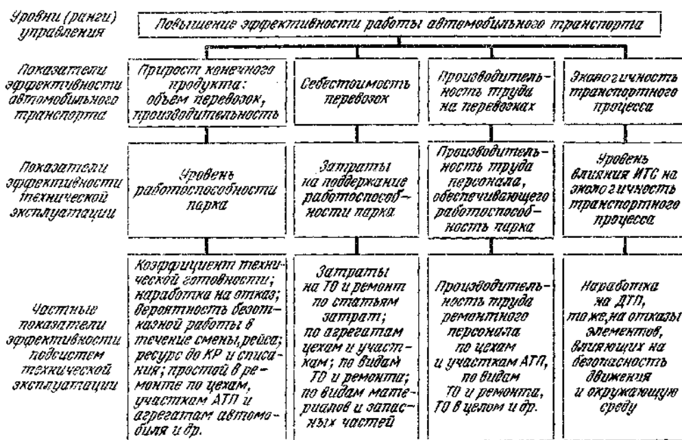
Рис. 5.6. Дерево целей, характеризующее связь показателей эффективности автомобильного транспорта и технической эксплуатации
