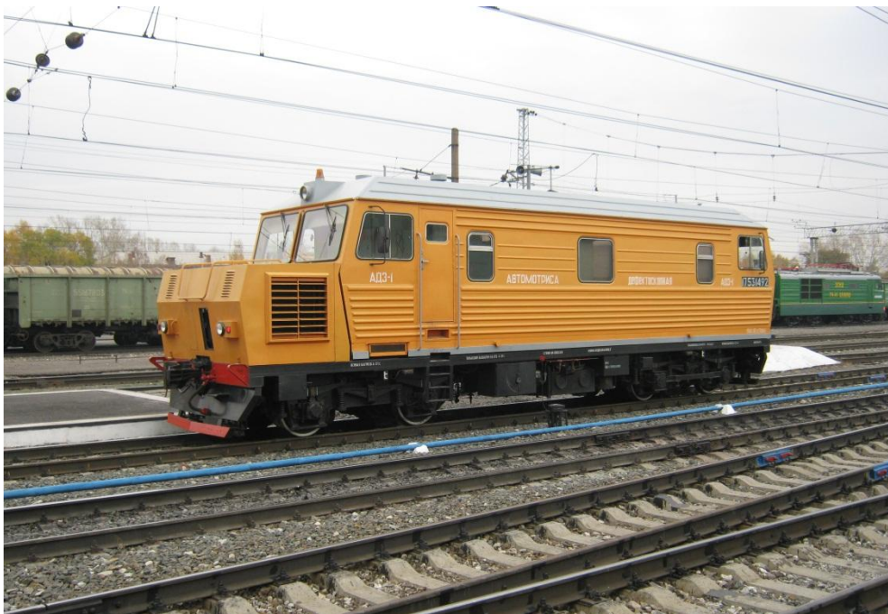
Рисунок 36. Автомотриса дефектоскопная электрическая АДЭ-1, Россия, 2011
