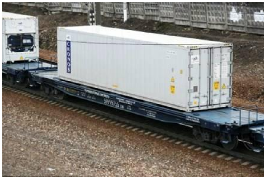
Рисунок 67. Специальная платформа для перевозки крупнотоннажных контейнеров
