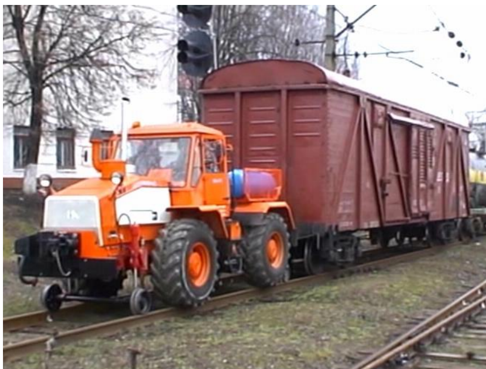
Рисунок 39. Мотовоз ММТ-2 на основе трактора ХТА-220
