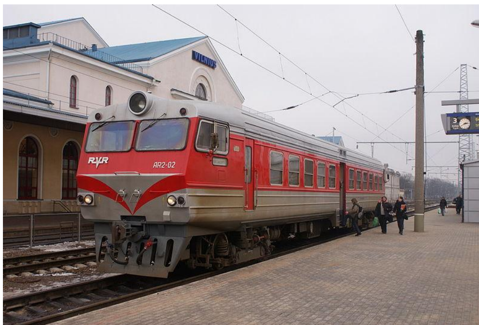
Рисунок 33. Дизельная пассажирская автомотриса AP2–002 производства Рижского вагоностроительного завода
