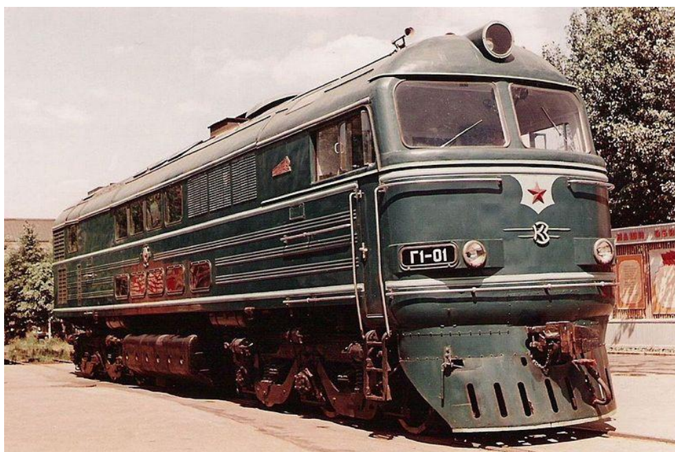
Рисунок 42. Газотурбовоз Г1-01 на территории Коломенского завода
