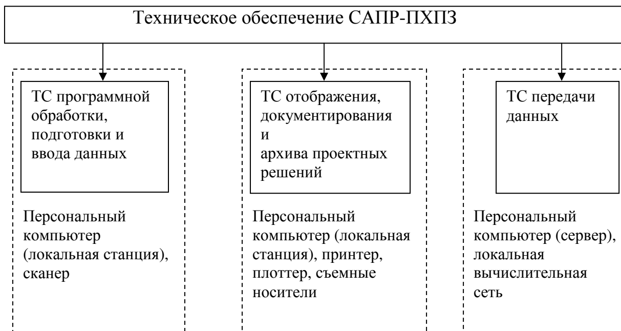
Рисунок 15 – Структурная схема ТС САПР-ПХПЗ
