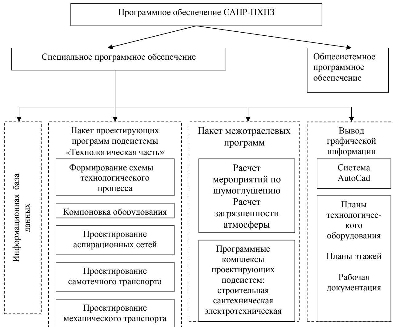
Рисунок 14 – Структура программного обеспечения САПР-ПХПЗ
