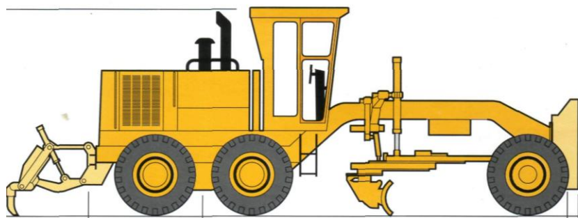
Рис. 11. Кирковщик с задним расположением на автогрейдер
