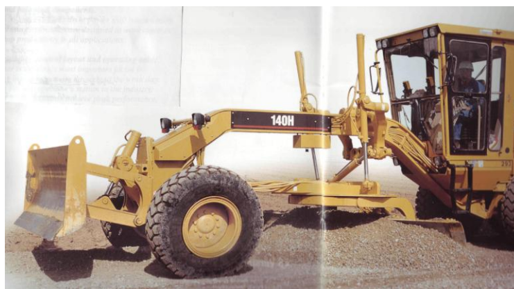
Рис. 12. Параллелограммная навеска бульдозерного отвала на передней стойке хребтовой рамы автогрейдера
