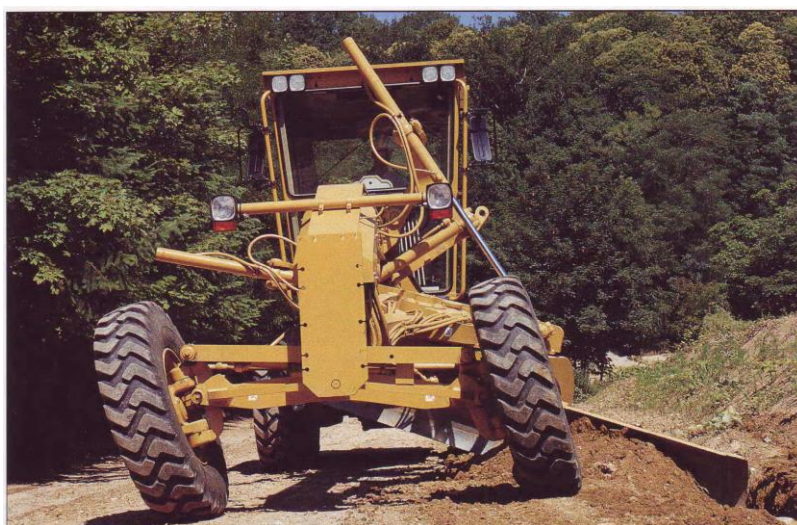
Рис. 6. Передний мост с управляемыми и наклонными колесами
