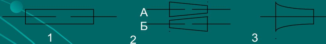
1 - Цилиндрические ( $\varphi=0,8$ ), 2 - Конические: А - сужающиеся ( $\varphi=0,9-0,95$ , для дальнобойной струи), Б - расширяющиеся ( $\varphi=0,5-0,55$ , для большого расхода при малой кинетической энергии), 3 - Коноидальные ( $\varphi=0,97$ ).
