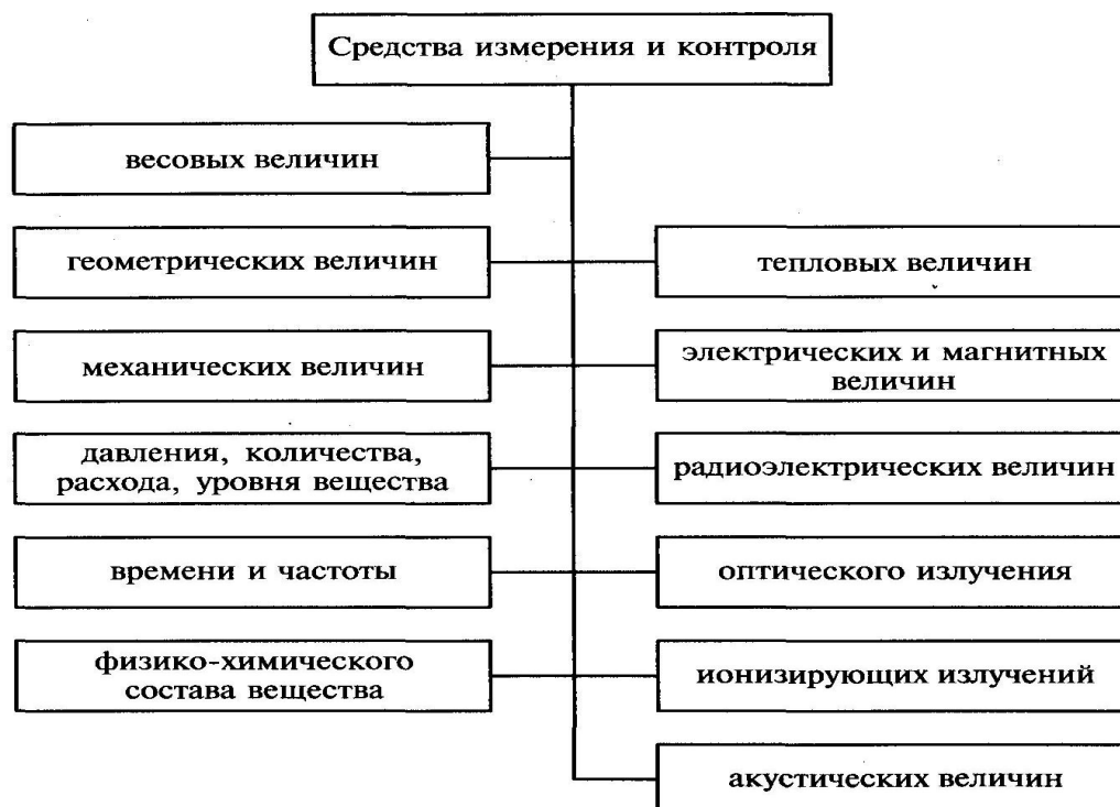
Рисунок 2.2. Классификация средств измерения и контроля по виду измеряемых геометрических величин
