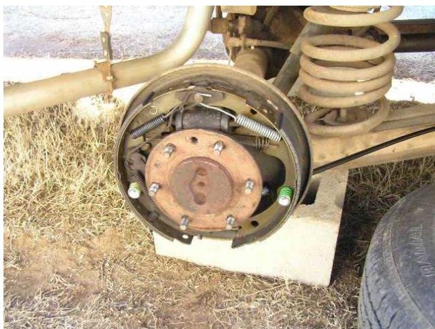
Рисунок 75. Барабанный тормозной механизм с гидроприводом и одним двусторонним гидроцилиндром
