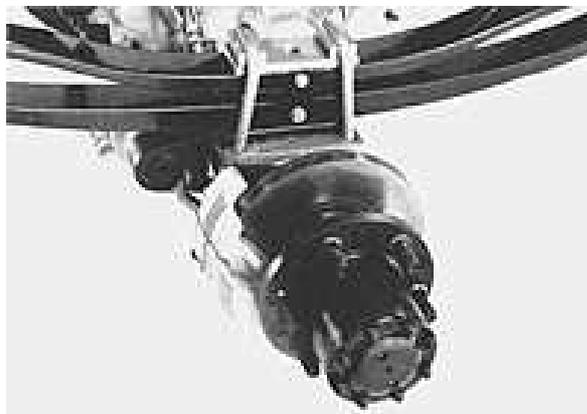
Рисунок 44. Однолистовая рессора из пластмассы
