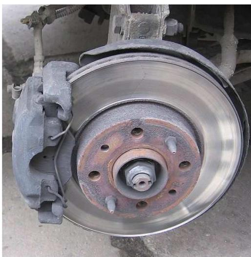
Рисунок 78. Дисковый тормозной механизм
