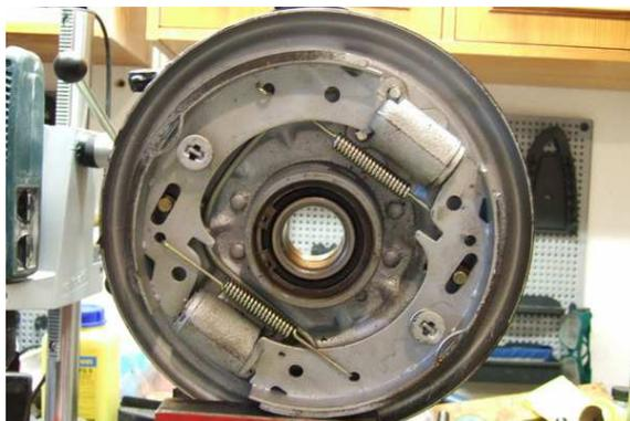
Рисунок 77. Барабанный тормозной механизм с двумя ведущими колодками (дуплексный).
