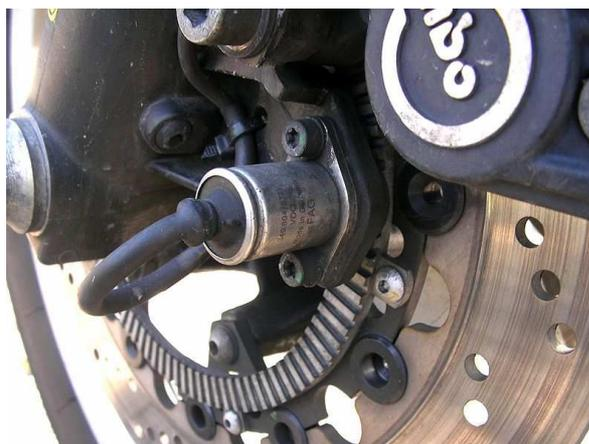
Рисунок 80. Электронный датчик скорости вращения колеса, используемый в системе ABS
