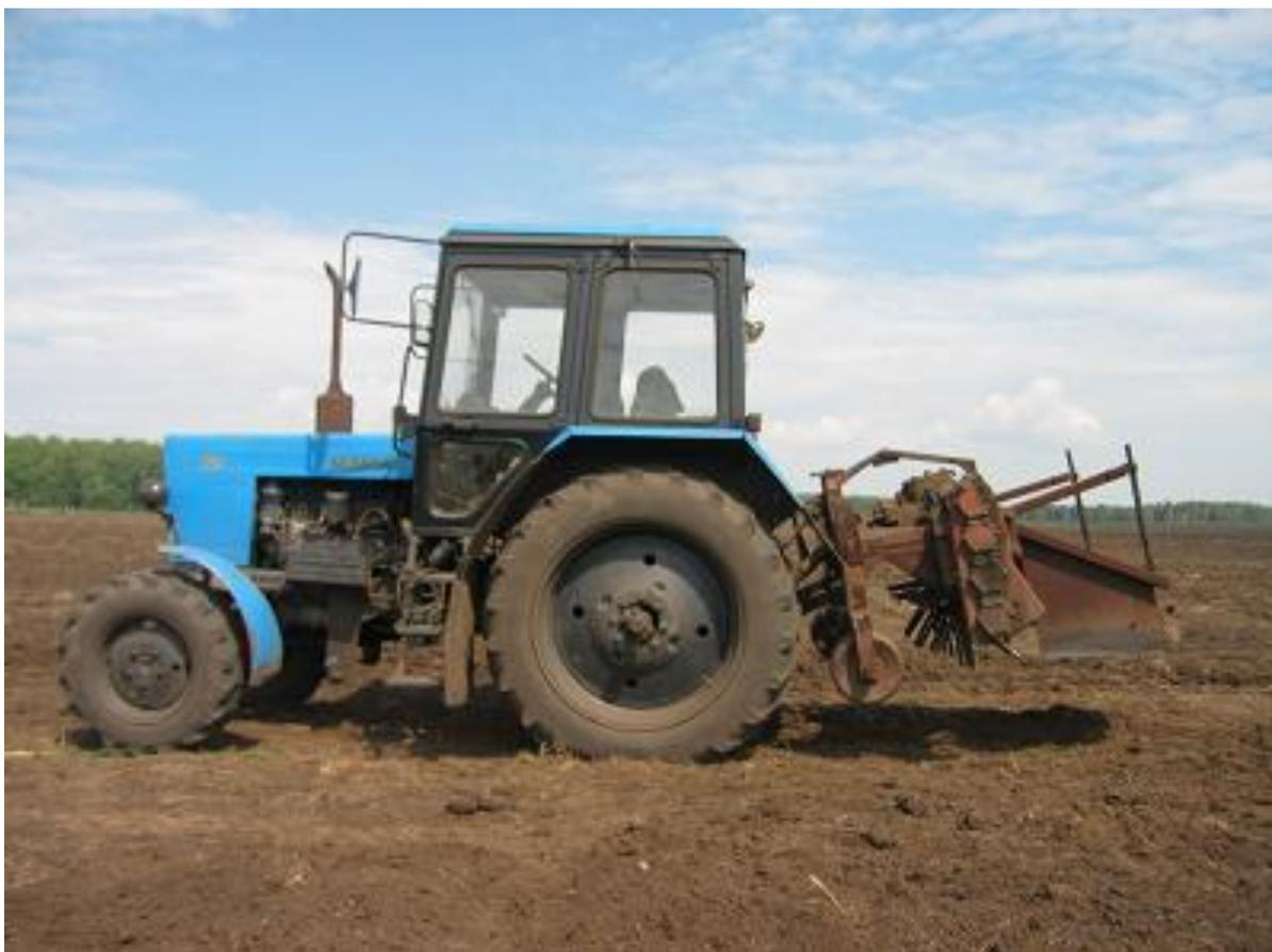
Рисунок 16– Общий вид грядообразователя фрезерного типа ГО-1,4 с шириной захвата 1,4 м
