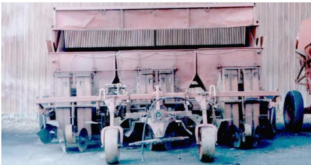
Рисунок 21 – Модернизированная картофелепосадочная машина КСМ – 6 с высаживающим аппаратом ленточно-транспортного типа
