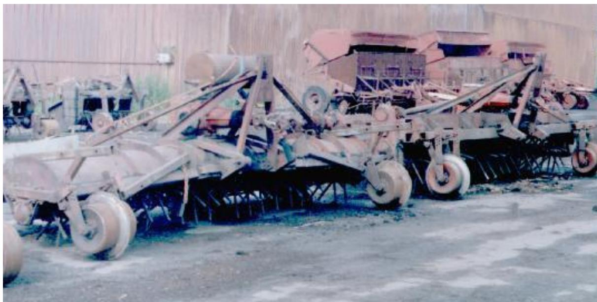
Рисунок 15 – Грядообразователь фрезерного типа с шириной захвата 4,2 м
