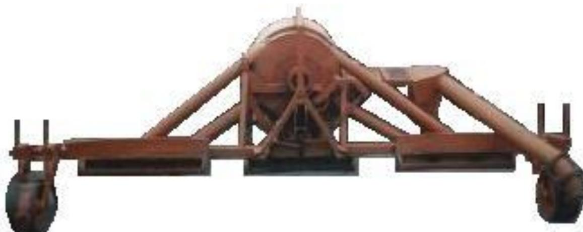
Рисунок 22 – Машина для сборки колорадского жука .
