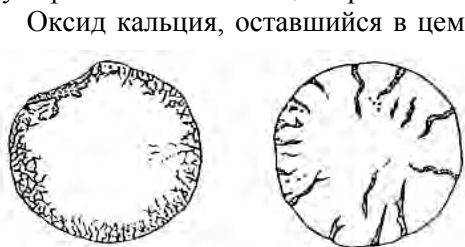
Рис. 10.30. Цементные образцы, не выдержавшие испытания на равномерность изменения объема
