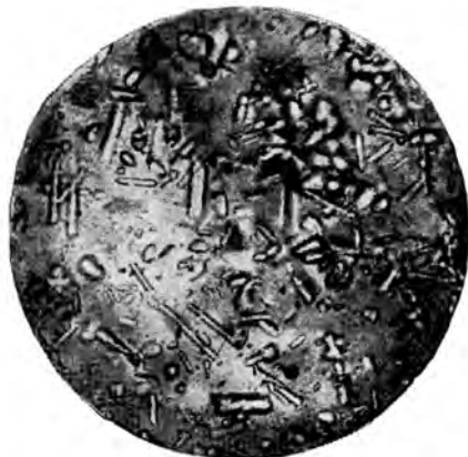
Рис. 7.6. Микрофотография кристаллов муллита в шамотном огнеупоре (×500)
