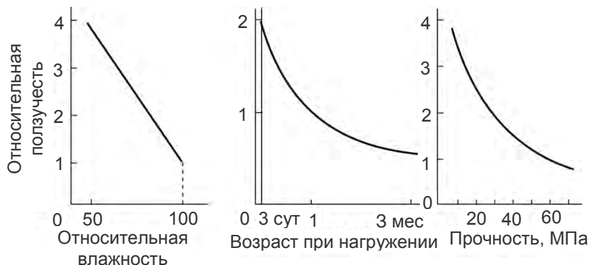
Рис. 11.16. Графики влияния основных факторов на относительную величину ползучести
