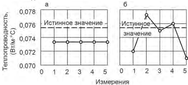
Рис. 1.1. Пример погрешностей измерений: а – систематическая; б – случайная
