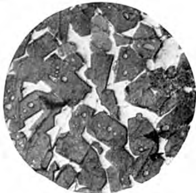
Рис. 10.18. Кристаллы алита в клинкере. Ув. 315
