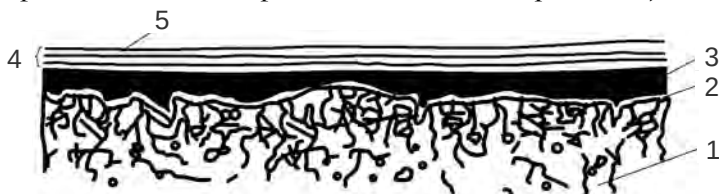
Рис. 15.1. Схема последовательного нанесения слоев лакокрасочного покрытия:
