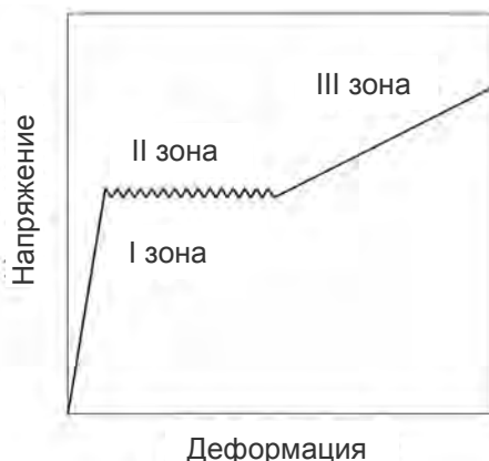
Рис. 11.47. Типичная кривая зависимости напряжение-деформация для цементных композиций, армированных волокном
