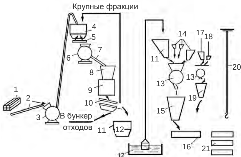
Рис. 12.26. Схема производства изделий из арболита на древесных отходах:
