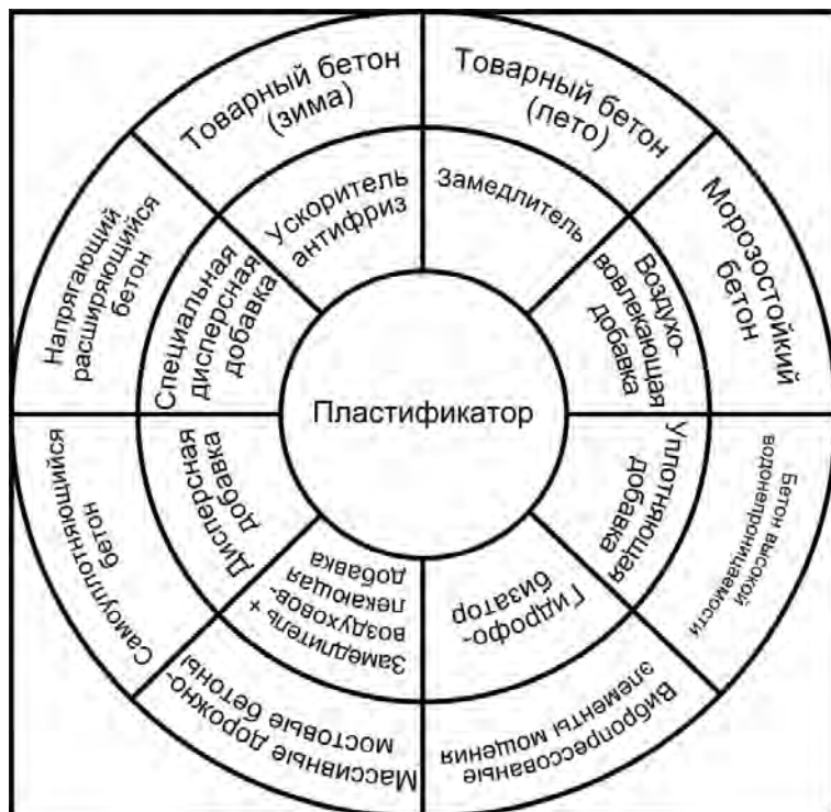
Рис. 11.3. Диаграмма формирования комплексных добавок (по А.В. Ушерову-Маршаку)
