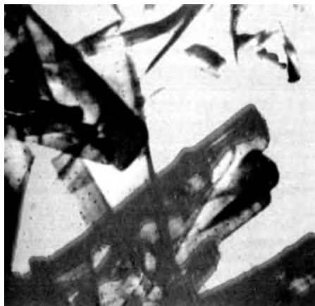
Рис. 10.24. Образование кристаллов этtringита в гидратирующей цементной системе
