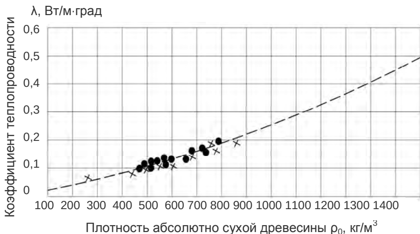
Рис. 12.9. Зависимость теплопроводности древесины поперек волокон от плотности в абсолютно сухом состоянии
