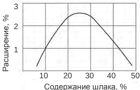
Рис. 10.39. Зависимость расширения напрягающего цемента от количества глиноземистого компонента
