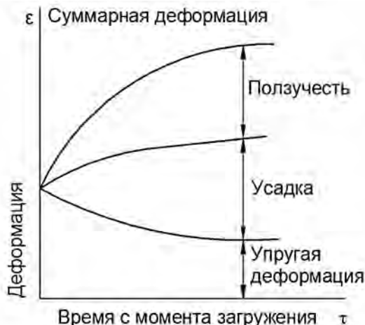
Рис. 3.4. Виды деформаций бетона \varepsilon , зависящие от времени \tau , при действии постоянной нагрузки
