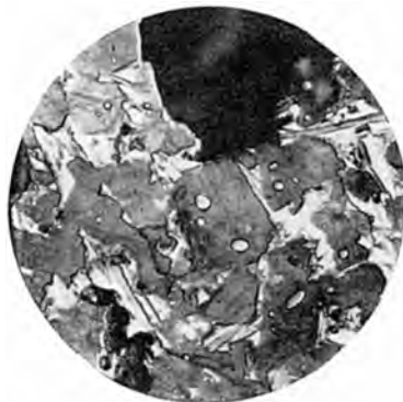
Рис. 10.22. Алитовый клинкер неравномернозернистой структуры. Ув.210
