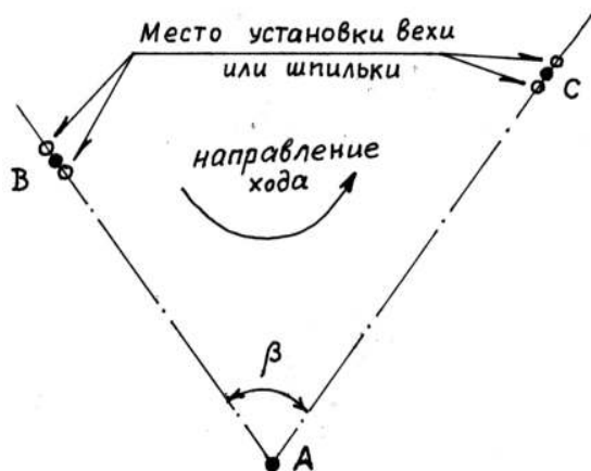
Рис. 7.22. Установка вех и шпилек при измерении горизонтальных углов
