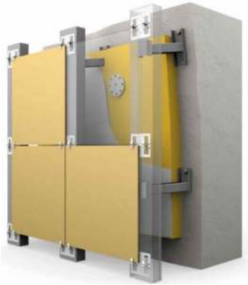
Рисунок 253 – Устройство вентилируемого фасада с облицовкой сайдингом
