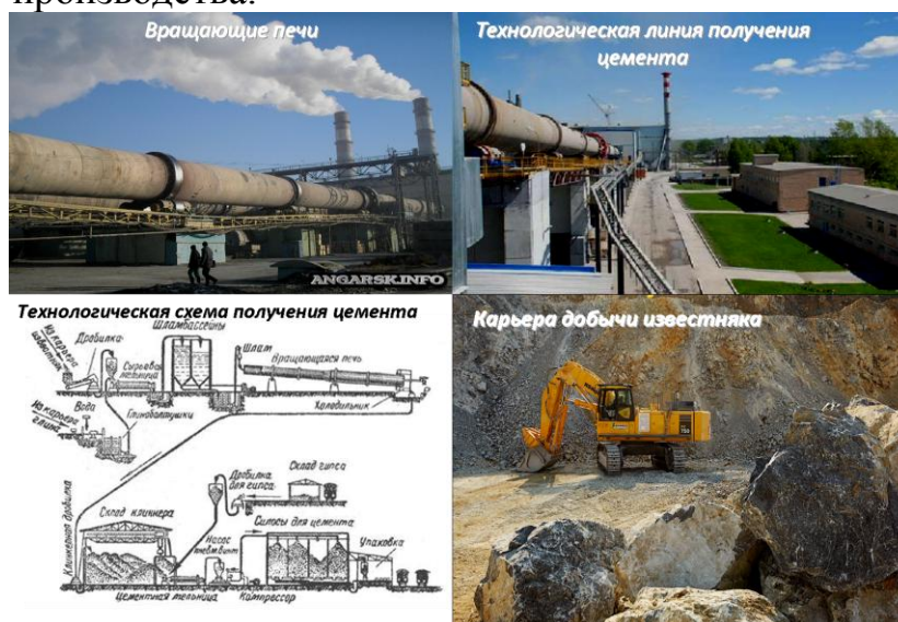
Рисунок 2 - Технология цементного производства
