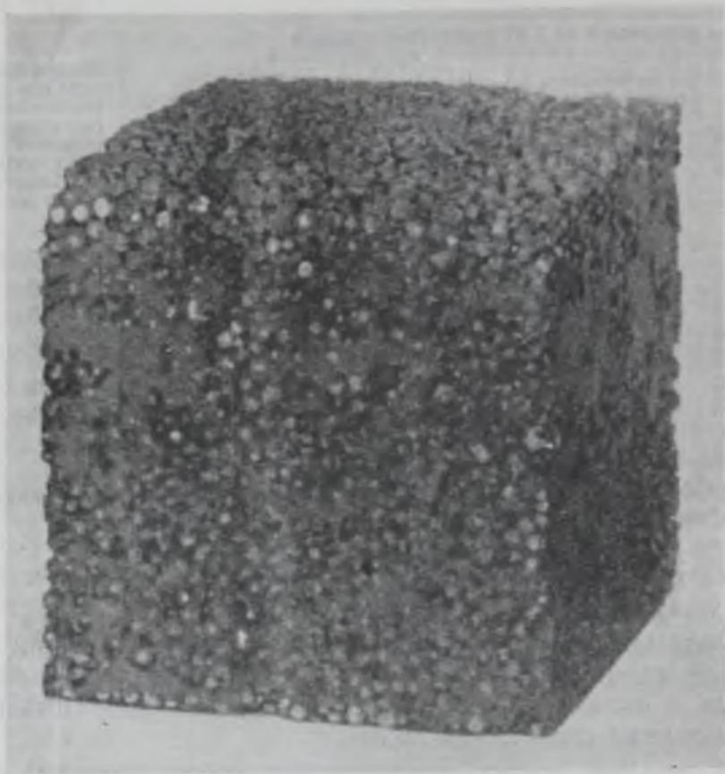
Рис. 3. Внешний вид образцов из легкого бетона марки 10 на вспененном полистироле
