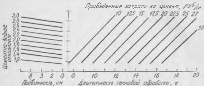
Рис. 4.10. Номограмма выбора оптимальной продолжительности тепловой обработки, обеспечивающей минимум затрат.
