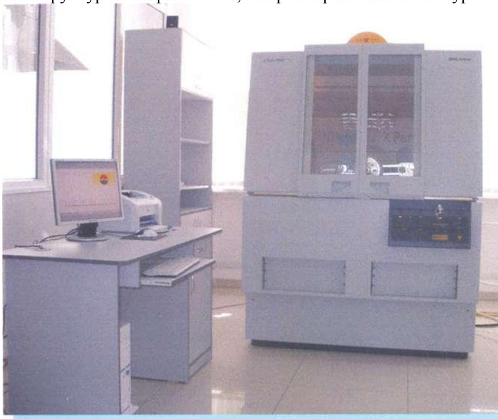
Диапазон измерения углов дифракции  $2\theta$ : от  $-12^\circ$  до  $+140^\circ$  Минимальный шаг сканирования:  $0,001^\circ$
