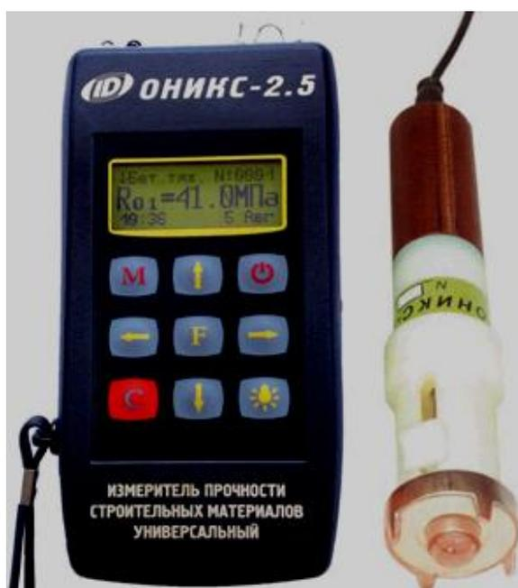
Рисунок 10.11 - Склерометр ОНИКС-2.5.
