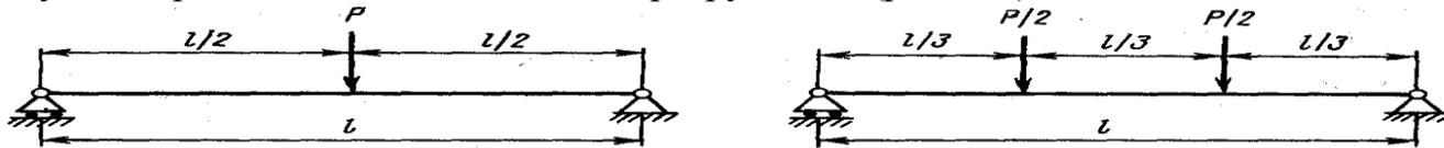
Рис. 1.2. Схемы стандартных испытаний на изгиб
