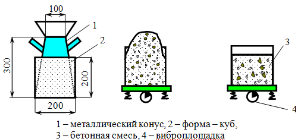
Рисунок 4.7 – Упрощенный способ определения жесткости бетонной смеси
