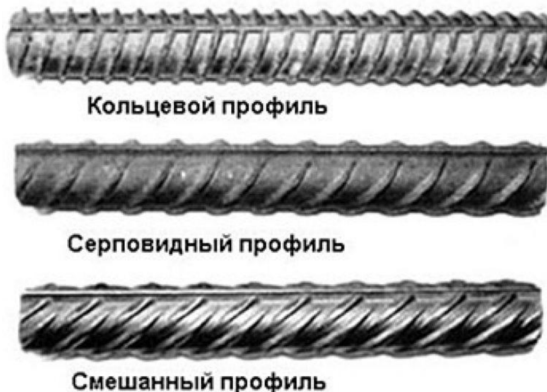
Рисунок 2.1 - Профили стержневой арматуры
