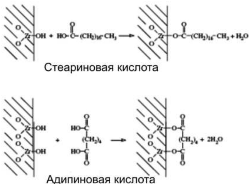
Рис. 101. Кислотно-основная стабилизация оксидных наночастиц
