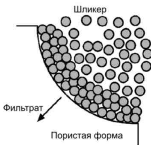
Рис. 24. Схема шликерного литья
