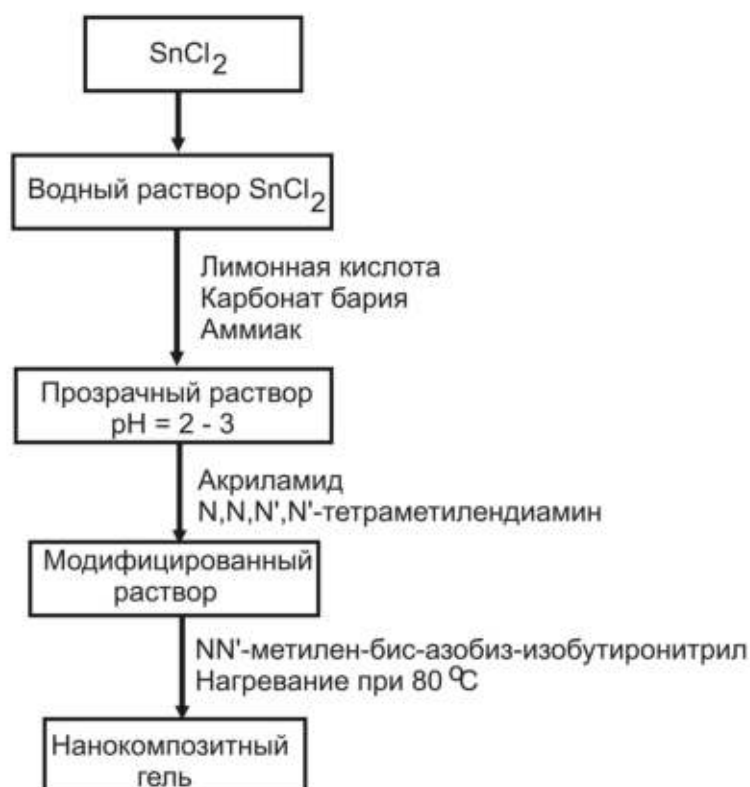
Рис. 18. Схема синтеза геля станната бария
