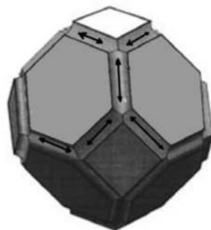
Рис. 38. Каналы пор, образующиеся на средней стадии спекания
