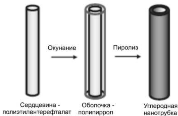
Рис. 83. Схема получения нанотрубок пиролизом полимерных волокон
