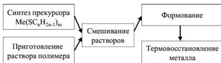
Рис. 95. Схема синтеза металл – полимерного композита термовосстановлением металла в полимере
