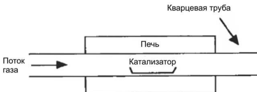
Рис. 79. Схема гетерогенного процесса синтеза углеродных нанотрубок методом каталитического крекинга углеводородов
