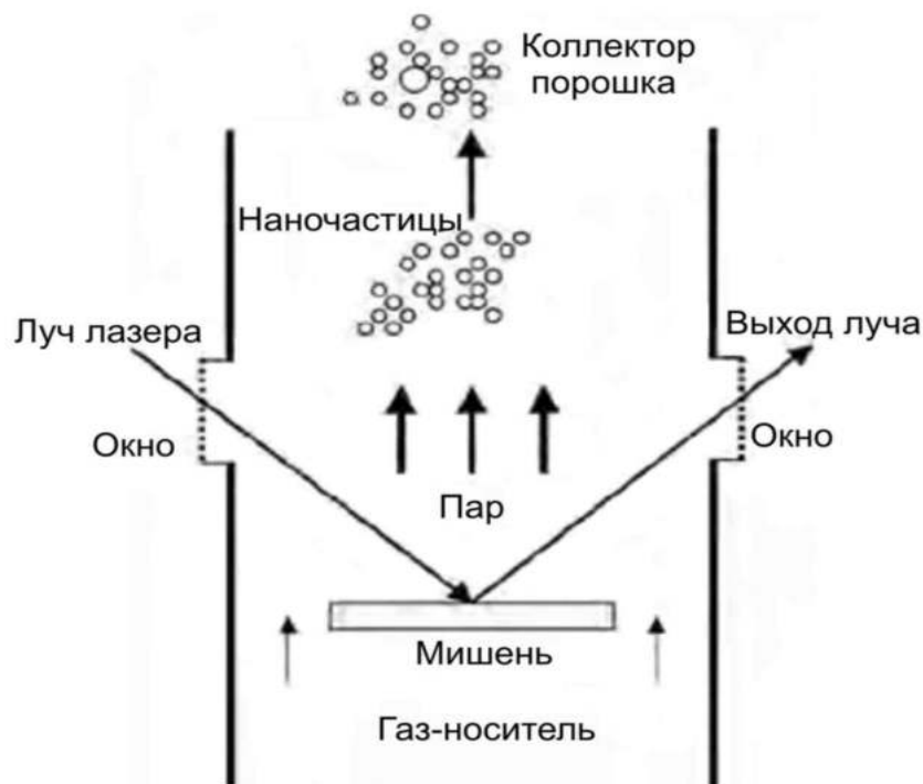
Рис. 22. Схема установки для лазерной абляции
