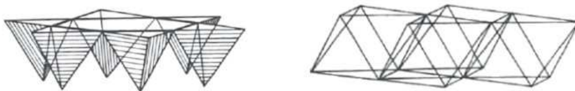
Рис. 66. Слои тетраэдров \text{SiO}_4 и октаэдров \text{MeO}_6 в структуре глин
