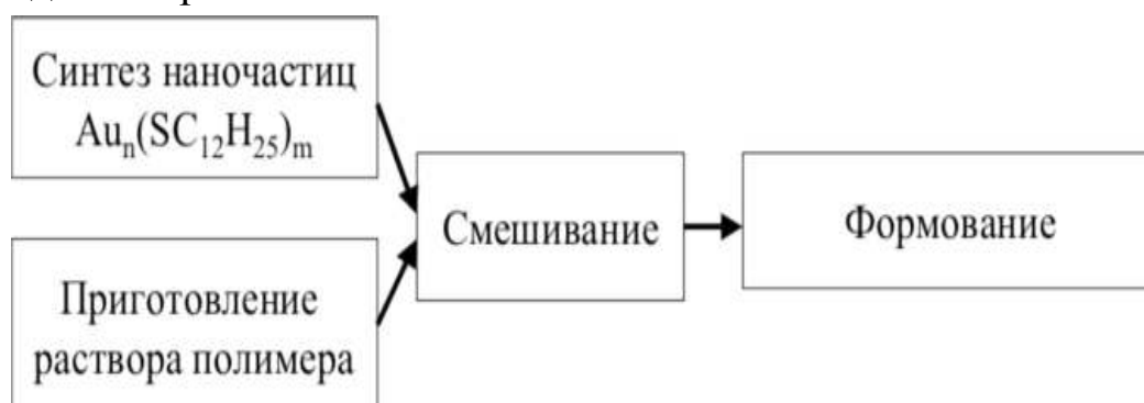
Рис. 96. Схема получения композита металл – полимер
