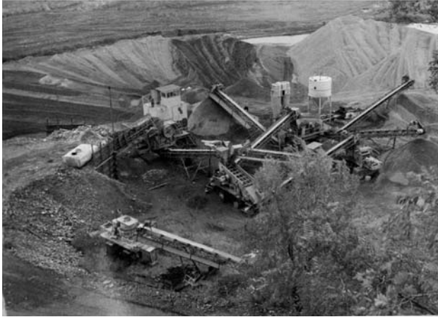
Фото 1 (схема Майская). Дробильно-сортировочный комплекс по переработке пород на шахте «Майская» пос. Майский
