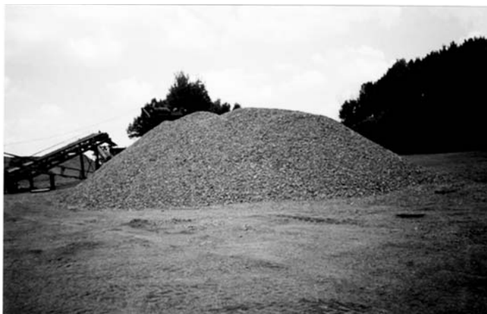
Фото 3 (Заполнитель. 26). Щебень из горелых шахтных пород
