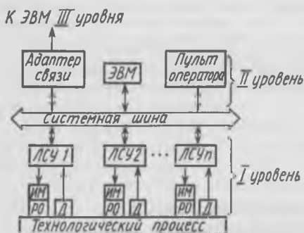
Рис. 71. Обобщенная схема структуры комплекса технических средств АСУ ТП
