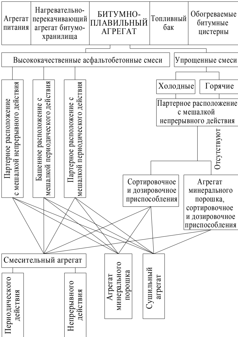
Рис. 7.2. Схема комплектации асфальтобетонного завода
