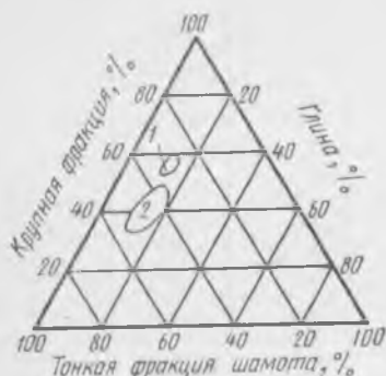
Рис. 7.5. Области максимального уплотнения трехфракционных порошковых масс:
