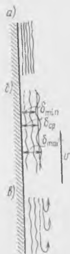
Рис. 4.21. Стекание пленки жидкости по вертикальной стенке:
