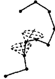
Рис. 2.7. Конформация цепи с фиксированными валентными углами.
