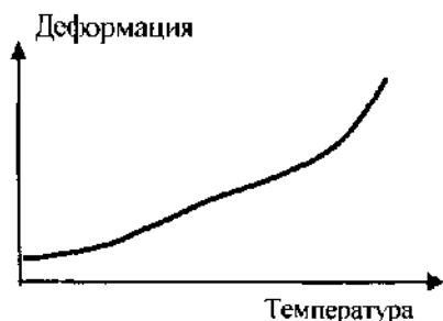
Рис. 6.11. Термомеханическая кривая полимолекулярных полимеров.
