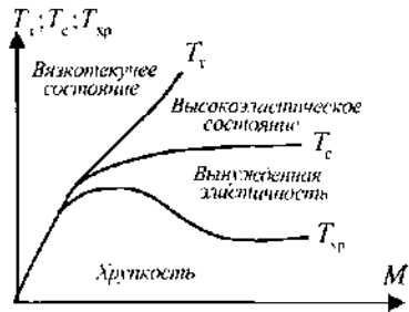
Рис. 7.10. Зависимость температур текучести, стеклования и хрупкости от молекулярной массы полимера.
