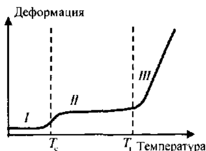
Рис. 6.9. Термомеханическая кривая аморфного линейного полимера.
