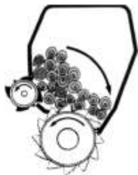
Рис. 3.4. Схема окорочного станка для круглых лесоматериалов
