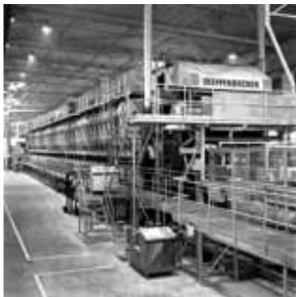
Главная установка в производстве MDF - проходной горячий пресс Dieffenbacher CPS длиной 46,7 м
