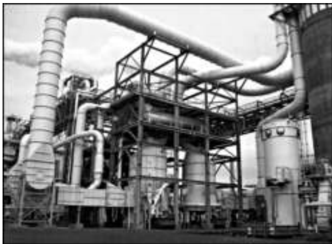
Рис. 5.13. Общий вид установки для сортировки стружки (иллюстрация предоставлена фирмой Dieffenbacher)
