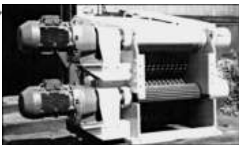
Рис. 3.17. Барабанная рубительная машина с принудительной загрузкой сырья: механизмы резания и подачи совмещены в едином корпусе, зубчатые валы механизма подачи оснащены зачистными гребёнками
