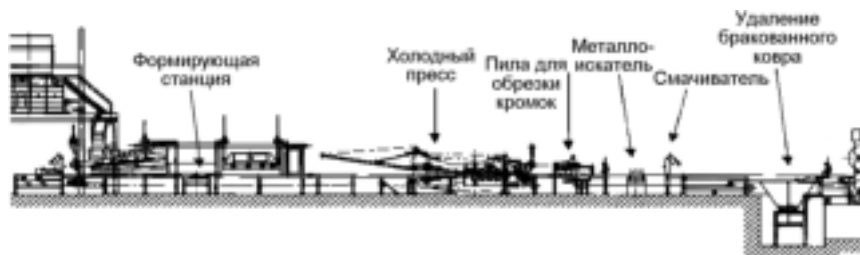
Рис. 7.2. Схема главного конвейера в производстве MDF (иллюстрация предоставлена фирмой Siempelkamp)
