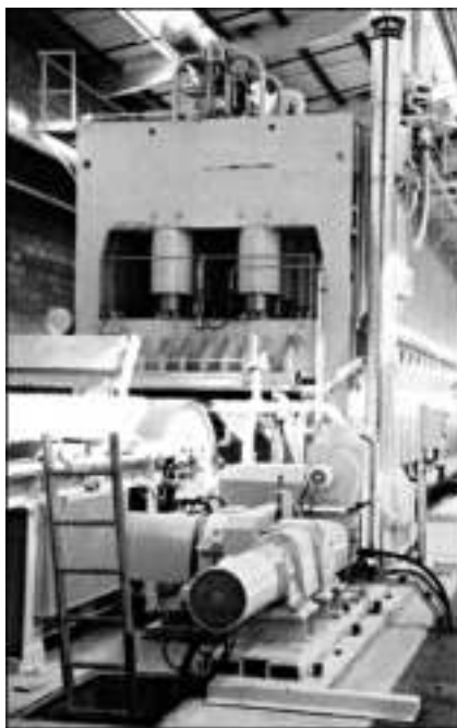
Рис. 8.8. Одноэтажный пресс для изготовления стружечных и волокнистых плит (иллюстрация предоставлена фирмой Dieffenbacher)
