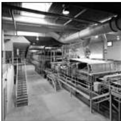
Рис. 8.1. Участок холодной подпрессовки стружечного или волокнистого ковра (иллюстрация предоставлена фирмой Dieftenbacher)
