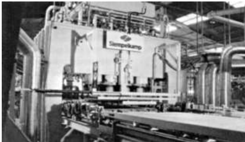
Многопоршневой пресс, например формата 2300 × 5800 мм, подходит и для изготовления плит с меньшими размерами
