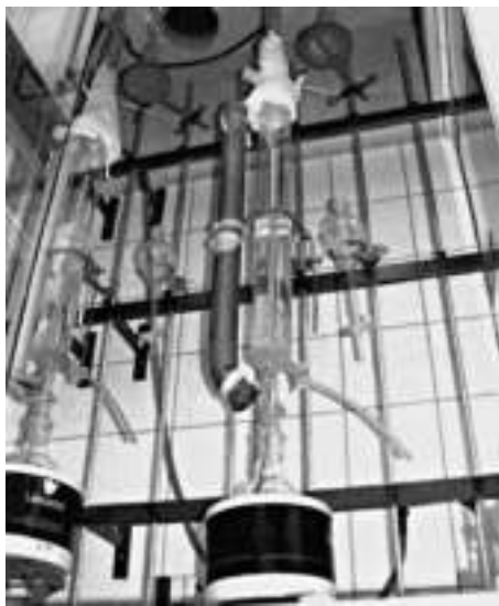
Рис 2.2. Установка для измерения содержания \text{CH}_2\text{O} в плите перфораторным методом EN 120
