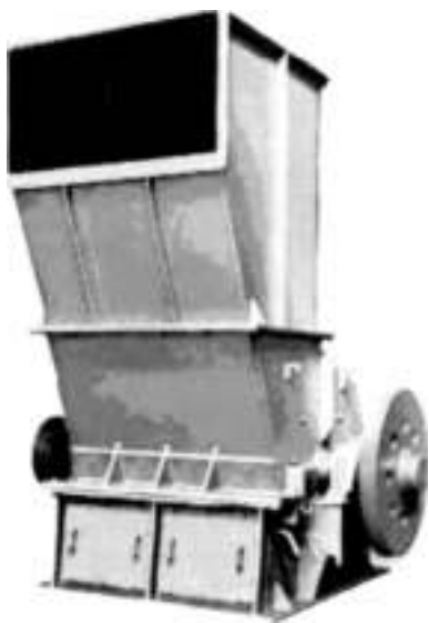
Рис. 3.15. Молотковая дробилка с вертикальной подачей сыпучего сырья
