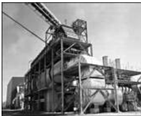
Рис. 5.6. Барабанная установка для сушки крупной стружки на заводе по выпуску плит OSB (иллюстрация представлена фирмой Dieffenbacher)
