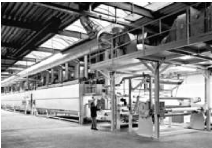
Рис. 10.2. Современная двухступенчатая пропиточная установка
