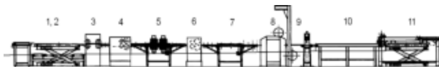
Рис. 10.7. Схема линии каширования на базе каландрового прессы: 1 – роликовый транспортёр, 2 – подъёмный стол, 3 – щёточный станок, 4 – вальцовый станок для нанесения отвердителя, 5 – канал инфракрасной сушки отвердителя, 6 – клеенаносящий станок, 7 – роликовый транспортёр, 8 – каландровый пресс (кашировальная установка), 9 – отсекающий плёнки, 10 – ленточный транспортёр, 11 – приёмный стол
