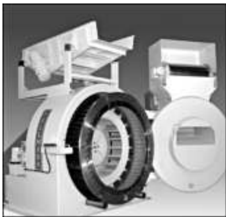
Рис. 4.2. Внутренний вид центробежного стружечного станка
