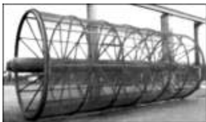
Рис. 3.19. Барабанная сортировка щепы
