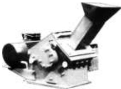
Рис. 3.16. Барабанная рубительная машина с гравитационной загрузкой сырья
