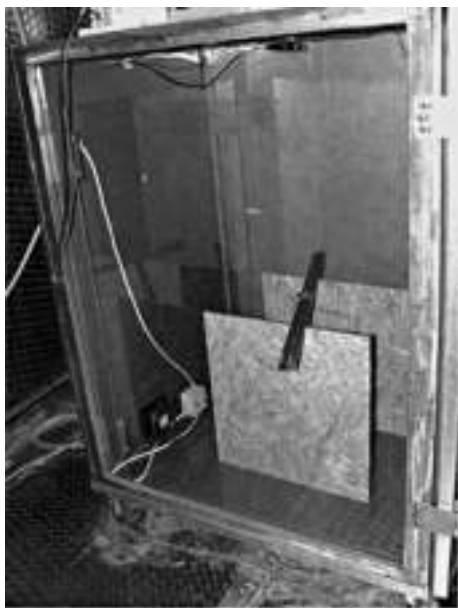
Рис. 4. Тестирование в климатической камере по методу ISO/DIS 12460-1
