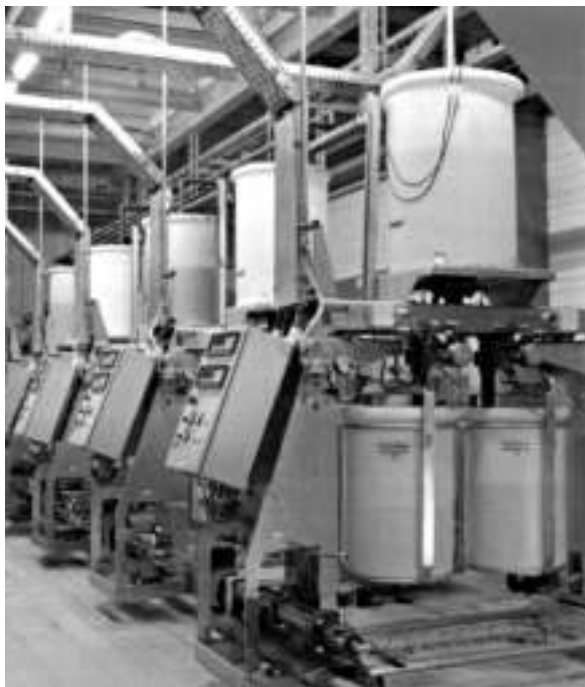
Рис. 6.7. Клееприготовительный участок в современном плитном производстве (иллюстрация предоставлена фирмой Dieffenbacher)
