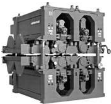
Рис. 9.5. Современный широколенточный шлифовальный станок, позволяющий оптимально распределить нагрузку между рабочими агрегатами (иллюстрация представлена фирмой Steinemann)
