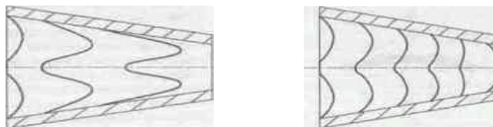
Рисунок 5. Распределение скоростей течения пластической (а) и тощей (б) масс в головке шнекового пресса.
