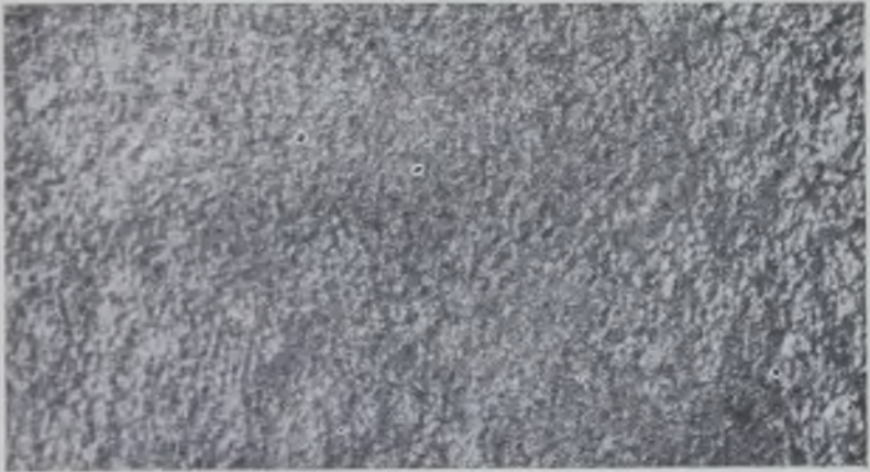
РИС. 32. МАКРОСТРУКТУРА ГАЗОШЛАКОБЕТОНА, ПОЛУЧЕННОГО ПРИ ДЛИТЕЛЬНОМ ПЕРЕМЕШИВАНИИ ПРИ ТЕМПЕРАТУРЕ ВОДЫ ЗАТВЕРЖЕНИЯ 50° С
