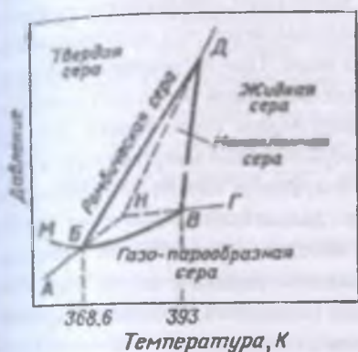
Рис. 2.2. Диаграмма состояния серы (температура в К).
