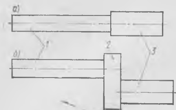
Рис. 4.15. Виды двухбарабанных печей
