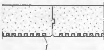
Рис. 72. Звукопоглощение ячеистого бетона, пазы которого заполнены пенопластом (1)
