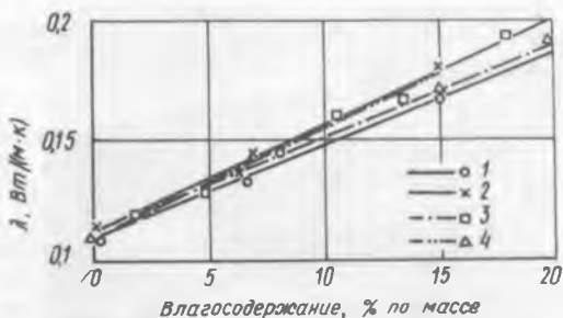
Рис. 9. Зависимость теплопроводности \lambda , измеренной приборами Кришера (1, 2, 3) и Ланга (4) при температуре 10^{\circ}\text{C} , от влагосодержания (по массе) ячеистого бетона плотностью 500 \text{ кг/м}^3 [10]
