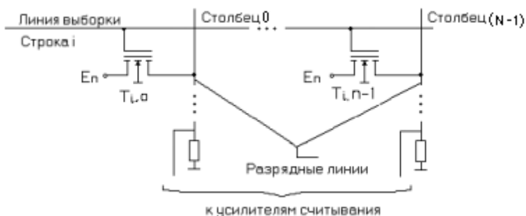
Рис. 5.29. Схема подключения двухзатворного ЛИЗМОП-транзистора к линиям выборки и считывания
