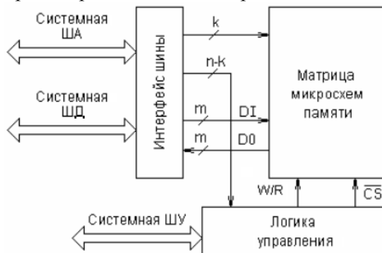
Рис. 5.1. Организация модуля ЗУПВ статического типа
