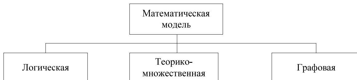
Рис. 1.8. Схема классификации математических моделей по форме представления свойств объекта
