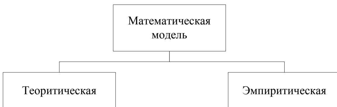
Рис. 1.7. Схема классификации математических моделей по способу получения модели
