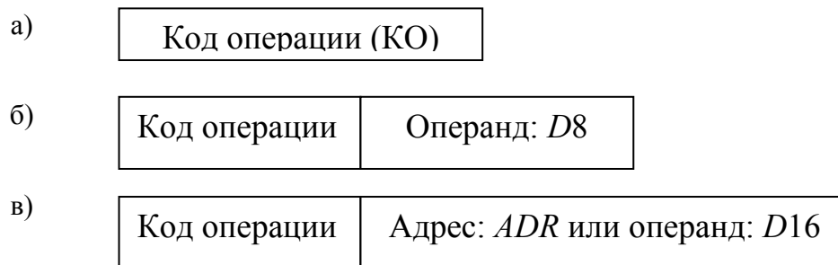
Рис. 1.16. Форматы команд микропроцессора KP580BM80A
