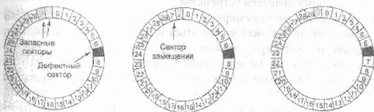
Рис. 9.2. Дорожка диска с дефектным сектором (а); замена дефектного сектора запасным (б); сдвиг всех секторов (в)
