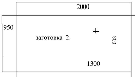
Рис.6. Карта раскроя заготовок спинок 1900x800x40 мм
