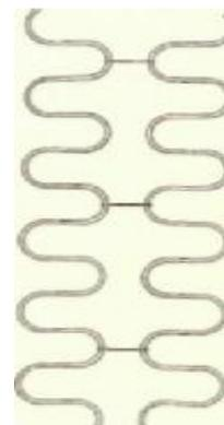
Рис. 42. Зигзагообразная пружина «змейка»
