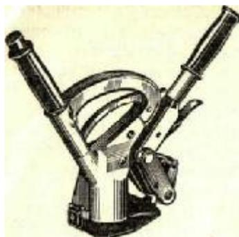
Рис. 56. Машинка для обвязки металлическими лентами
