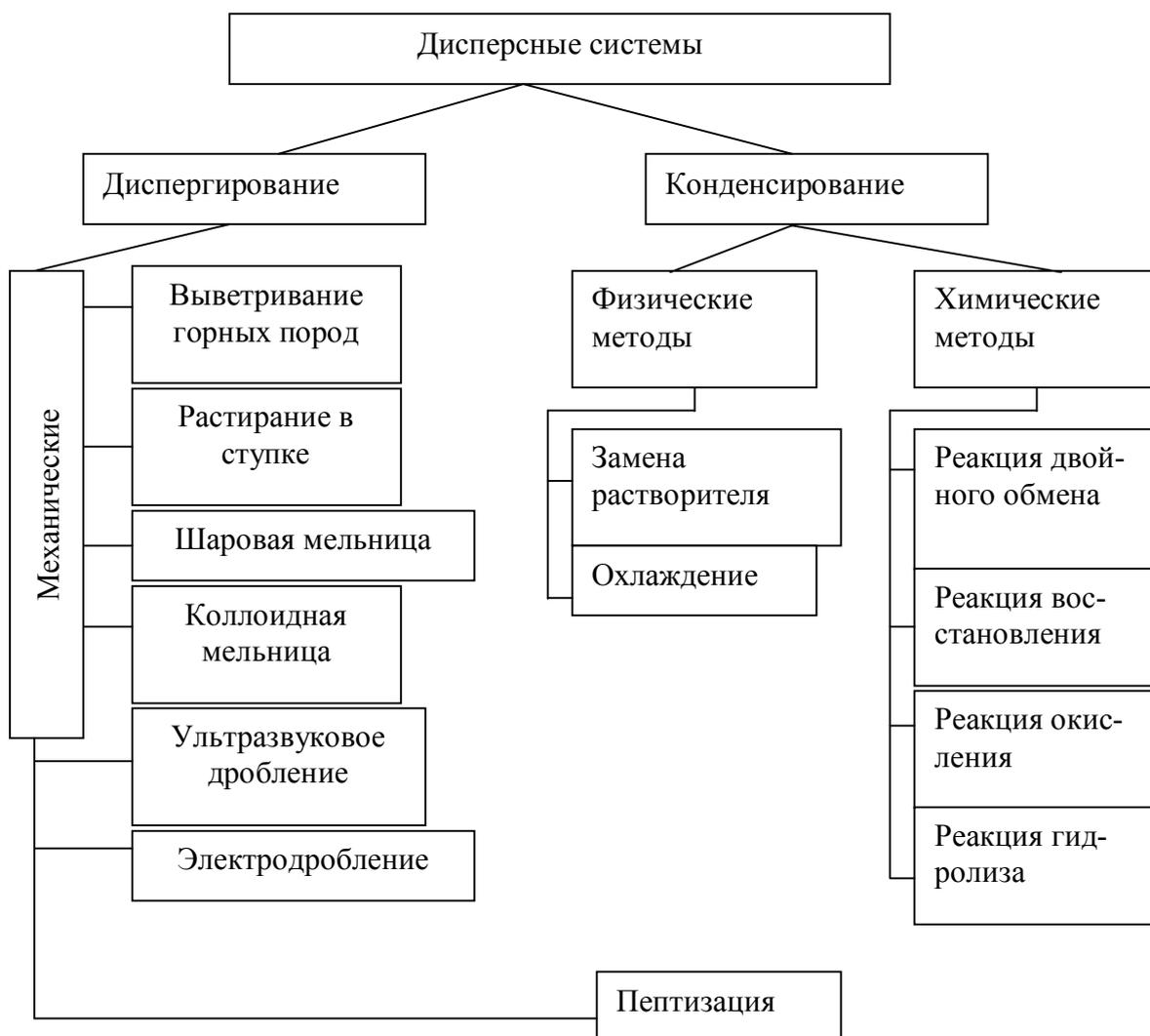
Рис.2.1 Методы получения лиофобных дисперсных систем
