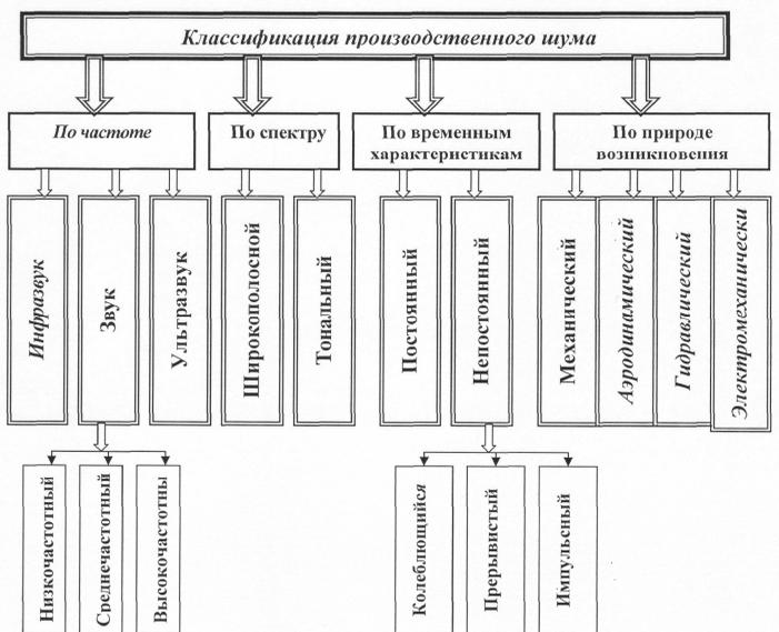
Рис. 26. Классификация производственного шума
