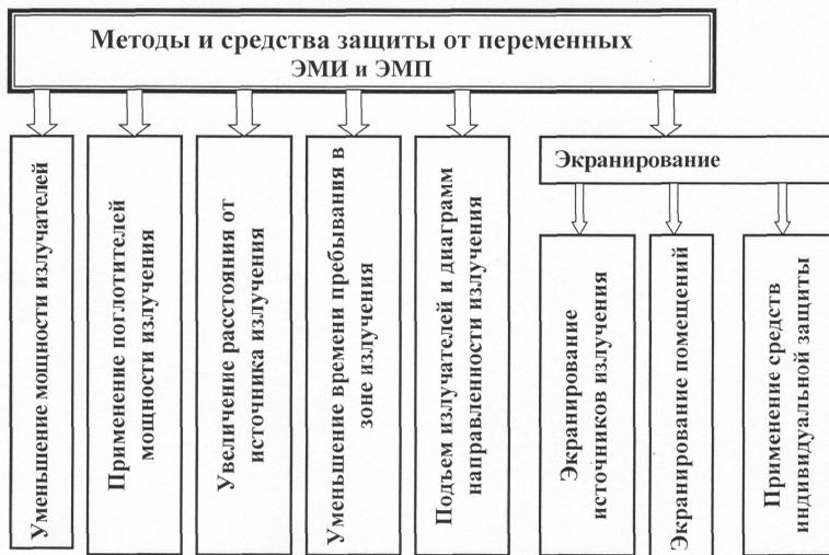
Рис. 14. Классификация методов и средств защиты от переменных электромагнитных полей и излучений
