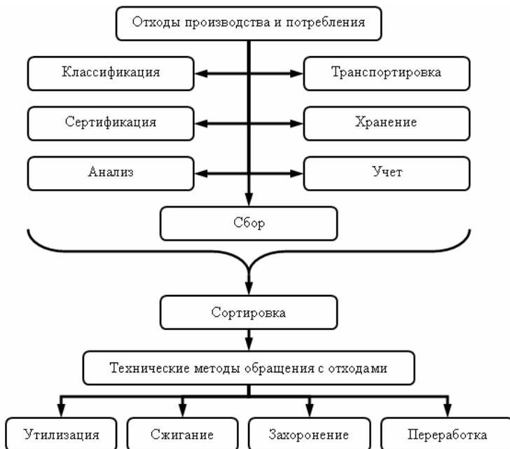
Рис. 30. Структурная схема обращения с отходами производства и потребления (по В. Т. Медведеву, 2002)
